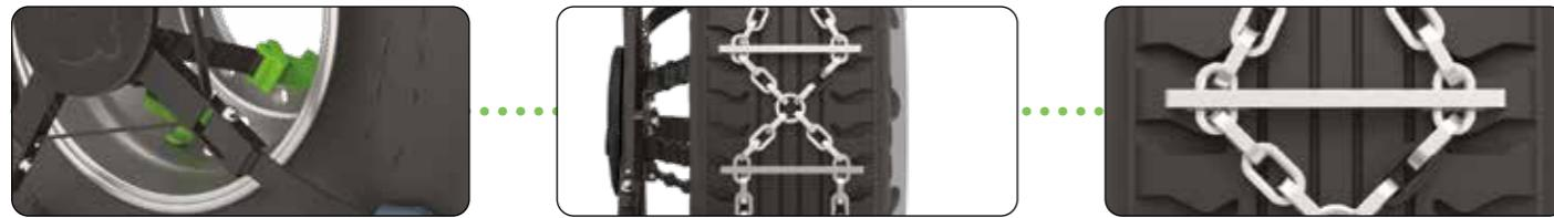
Veriga za tovorna vozila s hitro montažo. Tractiva CARGO je opremljena s členom 6 mm D profila. Nameščena z zunanje strani pnevmatike, s sistemom 4 ročic in jeklenimi karbonskimi konicami na 4 plastičnih vodilih.
